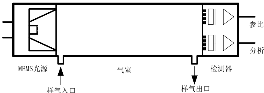
图 2.4.3-2 红外气体分析仪测量示意图
